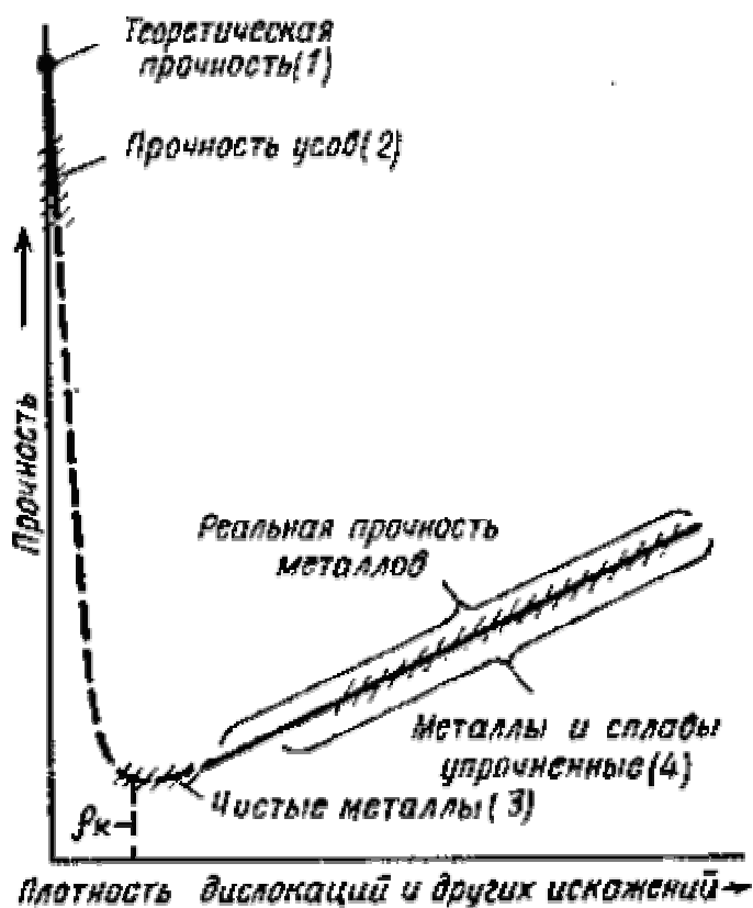
Рис. 2.5. Влияние плотности дислокаций на прочность
