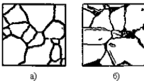
Рис.9.2. Микроструктуры технического железа: а – содержание углерода менее 0,006%; б – содержание углерода 0,006...0,02 %
