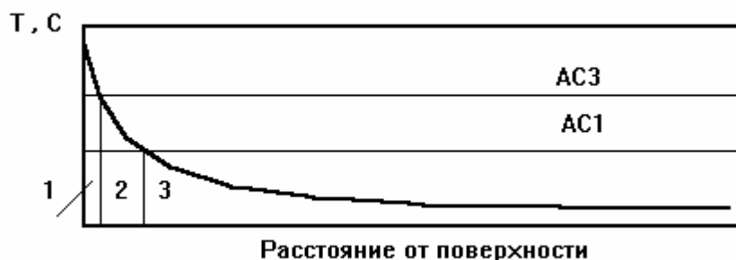
Рис. 48. Распределение температур по глубине при поверхностной закалке.
