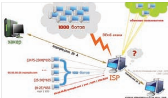
Схема проведения атаки на DNS при помощи ботнета
